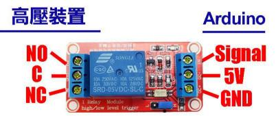
通常,高壓裝置的電路會連接到 NO 針腳和 C 針腳,即是平時電路是處於斷開的狀態。當我們改變 Arduino 那邊的信號時,電磁鐵便被激活,然後電路閉合,從而啟動高壓裝置。
