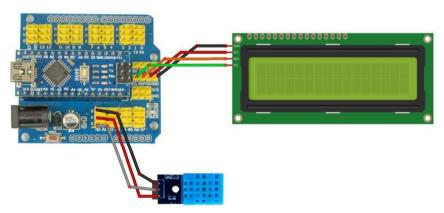
讓我們在連接 DHT11 感應器模組時驗證一下這個秘密吧。當我們用盡了 Arduino 主板上的所有其他數位針腳時,這個技巧就非常有用了。讓我們 將 DHT11 感應器模組的 DATA 針腳連接到模擬輸入針腳 AO。在上面的 例子中我們使用了一個 1602 I2C LCD 來顯示資料。
