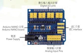
Arduino NANO 多用途擴展板是專為 Arduino NANO 而設,方便連接各類感應器的多用途擴展板。擴展板支援直接使用跳線,而每個輸入輸出針腳都配備了 5V 和 GND,以方便連接感應器模組。擴展板有獨立的 I2C 介面以供 I2C 設備使用。擴展板更有獨立的供電模組,為感應器和摩打提供額外的電源。
