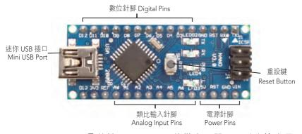
Arduino Nano 是基於 ATmega328 的微處理器,可以直接應用在麪包板上。它具有與 Arduino UNO 相同的功能,但體積更小。它沒有直流電源插孔,並改用了迷你 USB 插頭。
