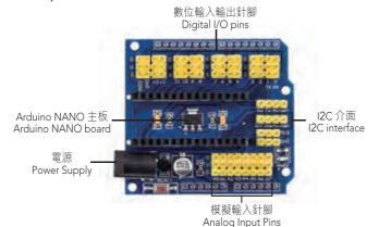
Arduino NANO 多用途擴展板是專為 Arduino NANO 而設,方便連接各類感應器的多用途擴展板。擴展板支援直接使用跳線,而每個輸入輸出針腳都配備了 5V 和 GND,以方便連接感應器模組。擴展板有獨立的 I2C 介面以供 I2C 設備使用。擴展板更有獨立的供電模組,為感應器和摩打提供額外的電源。
