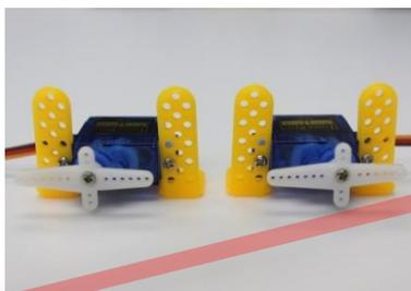
接著，用兩顆 6mm M3 尖頭螺絲每組伺服電動機多孔角碼固定在多孔固定膠板的左右兩邊中間的位置。
